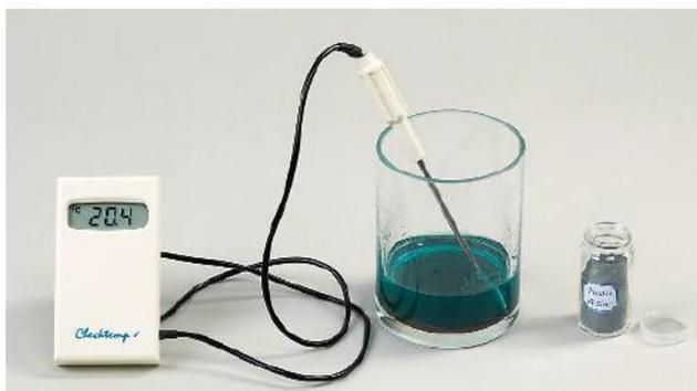
**C** On agite et quelques minutes plus tard on relève à nouveau la température. Une évolution de température indique l'apparition ou la disparition d'énergie thermique.
