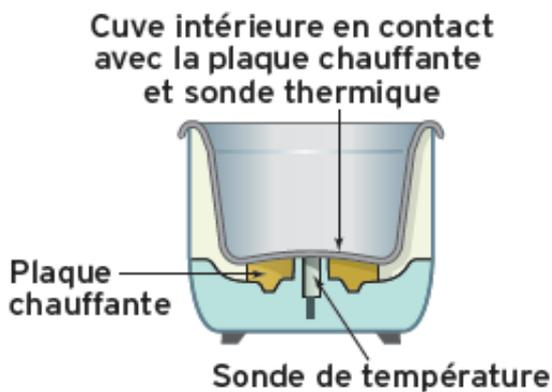
« La partie centrale extérieure de la cuve doit être parfaitement nettoyée. En effet, cette partie est en contact avec la sonde de température qui permet l'arrêt automatique du cuiseur. »
